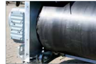
GURT Gurtqualität EP 400/3 2+0 Wenn nötig kann das Band auch mit Mitnehmern ausgerüstet werden
