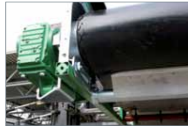
GURT Gurtqualität EP 400/3 2+0 Wenn nötig kann das Band auch mit Mitnehmern ausgerüstet werden
