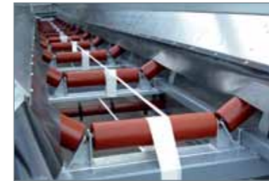
AUFBAU Rohrrahmenkonstruktion mit dreiteiligen Rollenstühlen
