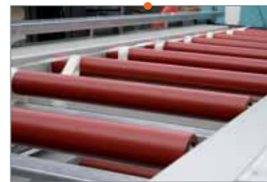
AUFBAU Rohrrahmenkonstruktion mit Rollen
