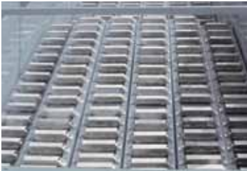
Siebfläche Breite Siebfläche mit Stahlpaddel
